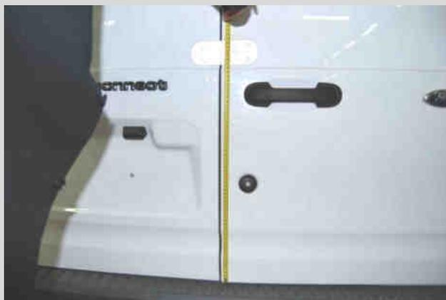
Prestare attenzione ai fori sul bordo estremo; prima di forare verificare che la testa del perno M8 sia contenuta nel bordo.
