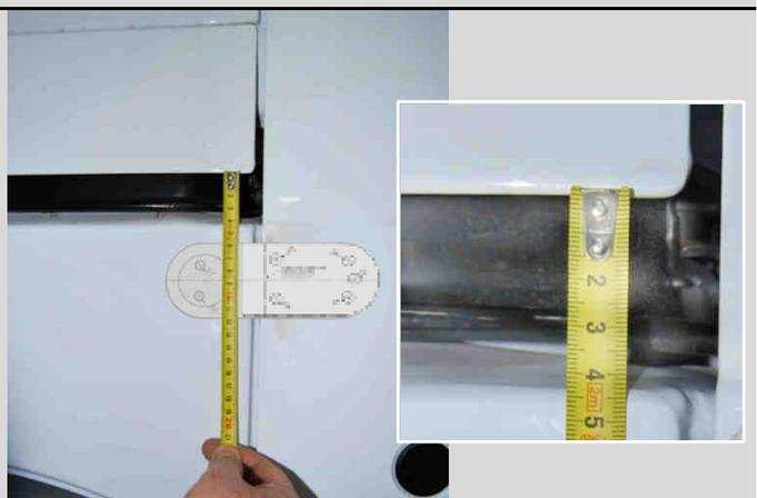
Al fine di fissare la contropiastra della corazza, distaccare senza rimuovere completamente la serratura laterale, svitando i tre perni laterali.
