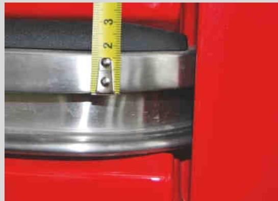
Per accedere ai perni della corazza dall'interno e fissare la contropiastra, è necessario distaccare e piegare temporaneamente la nervatura elettrosaldata sotto riportata.
