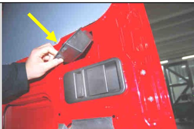
**NB:**Sul portellone posteriore, data la particolare conformazione delle lamiere, è preferibile installare la versione del lucchetto da 144mm (G4S); la versione da 164mm deborda di alcuni mm inficiando l'aspetto estetico.
