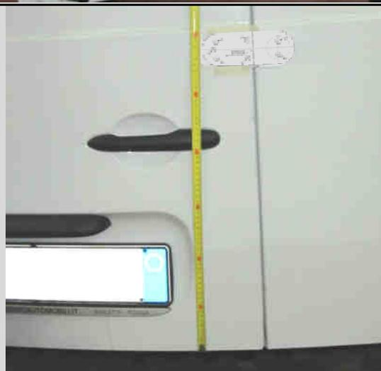
Per accedere comodamente alla zona di fissaggio del lucchetto è possibile smontare la serratura di serie, allontanandola dall'area di lavoro senza rimuoverla completamente.
