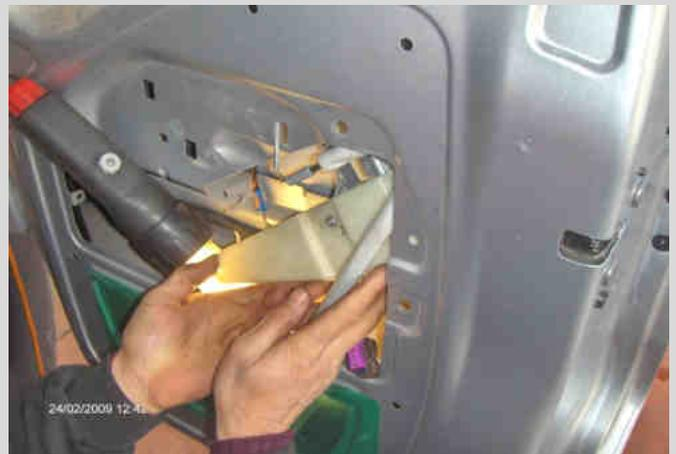
Svitare le due viti e, dopo aver scollegato il cavo di alimentazione, sfilare infine l'elettro-serratura.
