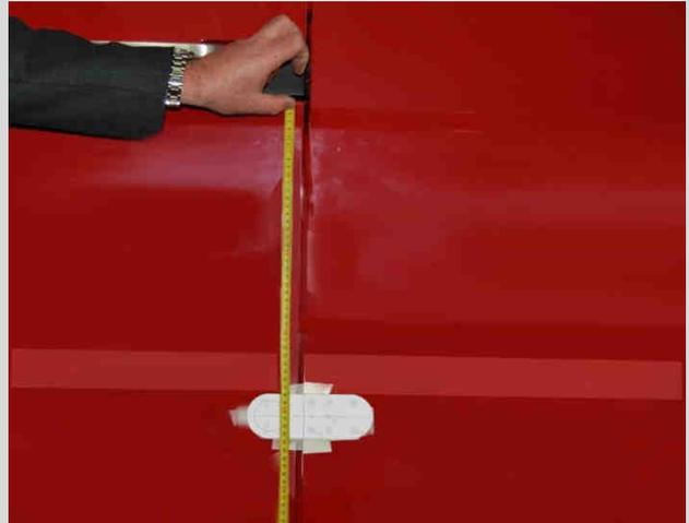
In corrispondenza del centro del pomello, praticare con una fresa a tazza da 50 un foro dall'interno del vano di carico per rimuovere la doppia lamiera interna e per poter applicare la contro-piastra del pomello. Servirsi di un foro di guida eseguito dall'esterno in corrispondenza del centro del pomello.
