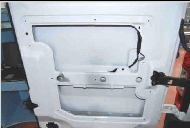
Smontare la manopola e la maniglia, sganciando le leve interne. Non è necessario smontare la serratura di serie.
