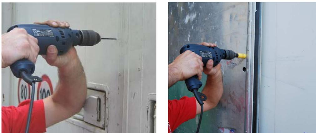
Fresar y eliminar los eventuales bordes cortantes del foro de 20-22mm para posicionar y alinear correctamente los espaciadores. A continuación se representa la configuración final de los foros de la puerta del lado interno de los conos.
