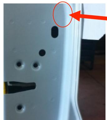
Svitare la vite di tenuta del supporto maniglia e distaccare lo stesso supporto senza estrarlo dal portellone. Lo spostamento è sufficiente a garantire l'accesso per il fissaggio della contro piastra.
