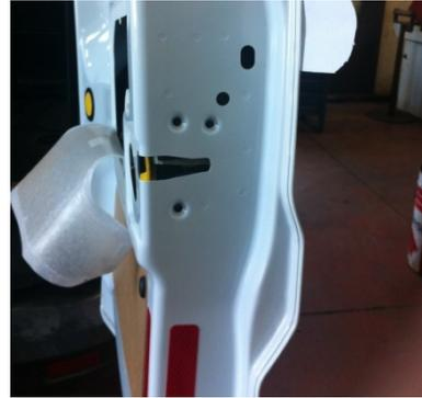
Lateralmente rispetto al portellone svitare la vite di tenuta del blocchetto esterno della maniglia (senza rimuovere completamente la stessa vite). Estrarre il blocchetto e sfilare l'impugnatura della maniglia.
