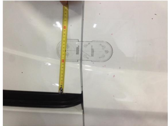
Unire utilizzando carta gommata (o altro nastro adesivo) la contropiastra ad una asta/lastra (con spessore inferiore ai 3mm) in acciaio o plastica per avere una buona maneggevolezza e rigidezza.
