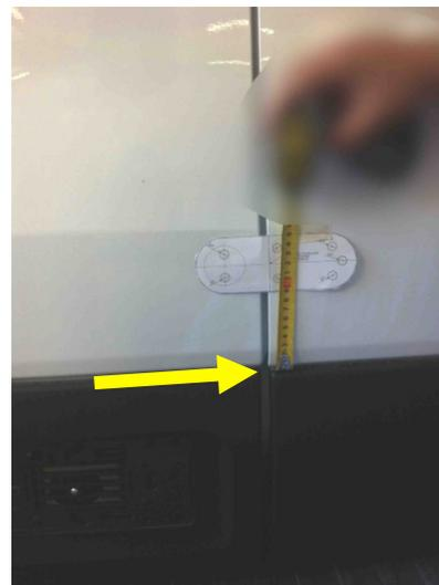
Per agevolare il fissaggio dall'interno della contro piastra della corazza, è preferibile distaccare la serratura di serie. È sufficiente svitare le viti di fissaggio ed allontanare semplicemente senza però smontare il corpo della serratura.
