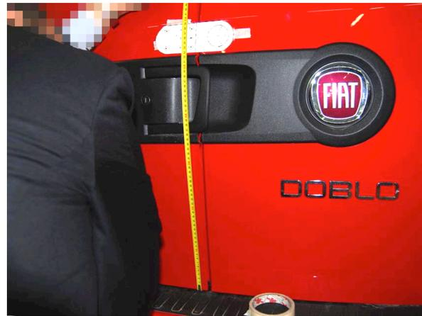
Per fissare la corazza è preferibile distaccare la serratura, senza rimuoverla completamente.
