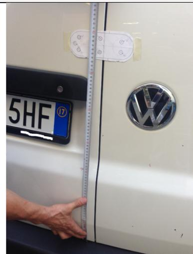
Dal momento che la dimensione del bordo interno che alloggia la testa del perno M8 a bottone è ridotta, **spostare di circa 2-3 mm la dima a destra** (in questo modo i fori si avvicinano al bordo).
