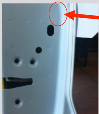
Desenroscar los tornillos de fijacion del soporte de la manija y alejar el mismo sin extraerlo de la puerta. Con solo alejarlo se garantiza el acceso para la fijacion de la placa de refuerzo.
