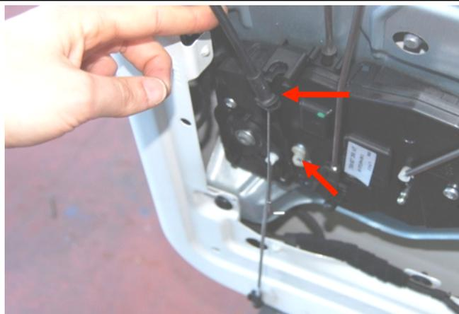
Desenganchar las varillas indicadas en la figura prestando atención a marcar la posición de origen (utilizar una fibra o cinta adhesiva).
