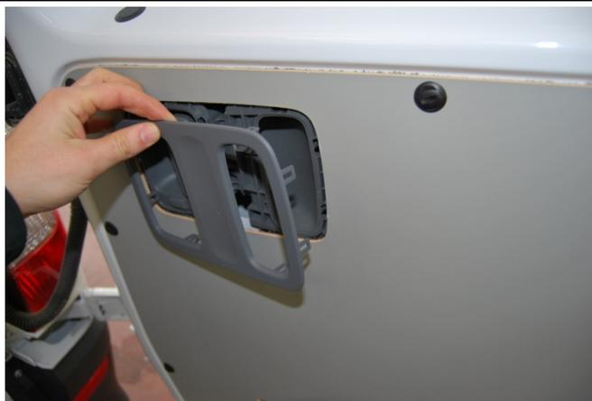
Aplicar la plantilla de perforación. En particular, el eje longitudinal del candado es de 32cm del borde inferior de la puerta (verificar que el candado no vaya más allá de la cavidad de la chapa que se corresponde con la patente).
