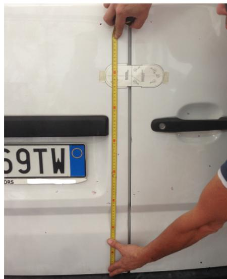
Corte la placa del gancho como se indica en la foto (unos 3 cm). De esta forma encajará perfectamente en el asiento interno existente. Compruebe que no haya interferencia con la cerradura original del vehículo.
