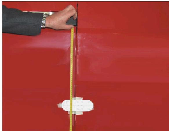
En correspondencia con el centro del cono, realizar con una fresa tasa de "50", un agujero desde el interior de la zona de carga para quitar la doble chapa interna y para poder aplicar la placa interna del cono. Ayudarse con un agujero de guía realizado desde el exterior en correspondencia con el centro del cono.
