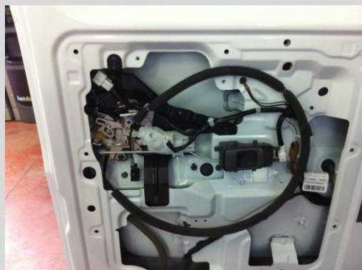
Aplicar la plantilla de perforación. En particular, el eje longitudinal del cuerpo del candado esta a  $75\text{cm}$  del borde superior de la falda negra de plástico de la puerta (ver foto lateral).
