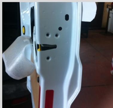
Lateralmente respecto a la puerta, desenroscar los tornillos de fijacion del cilindro externo de la manija (Sin remover completamente los mismos tornillos).
