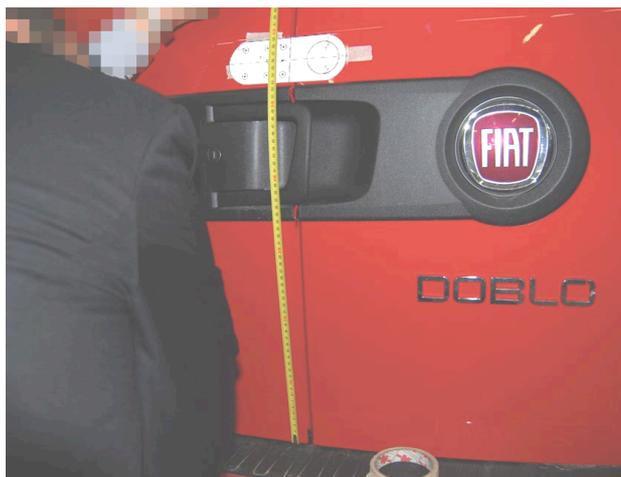
Para facilitar la instalación, se aconseja mover la cerradura original del vehículo, sin sacarla completamente. Para ello, desenroscar los tornillos externos y desenganchar los tirantes a la altura de los clips de plástico (como indicado en la foto).
