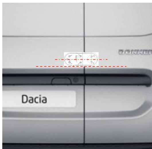
Cortar la placa de refuerzo como se indica en la foto. De esta forma encajará perfectamente en el asiento interno existente.
