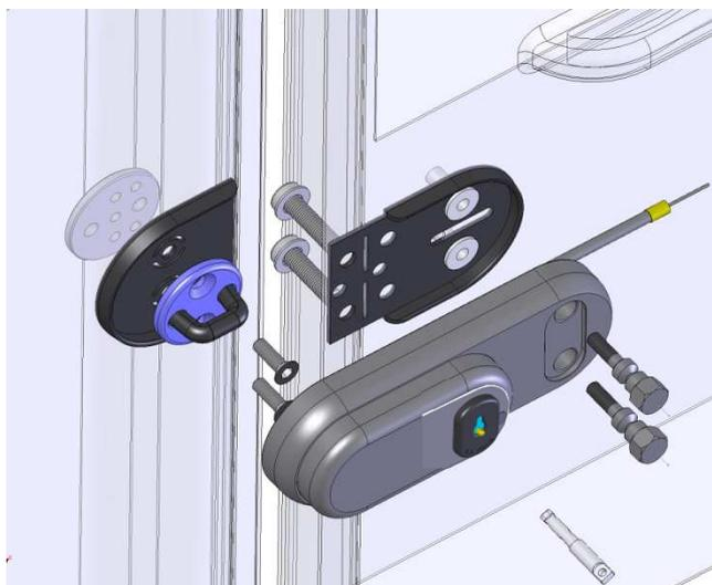
Metodo rapido + contropiastra interna di rinforzo solo per il riscontro (Semplifica il montaggio e garantisce una buona resistenza);
