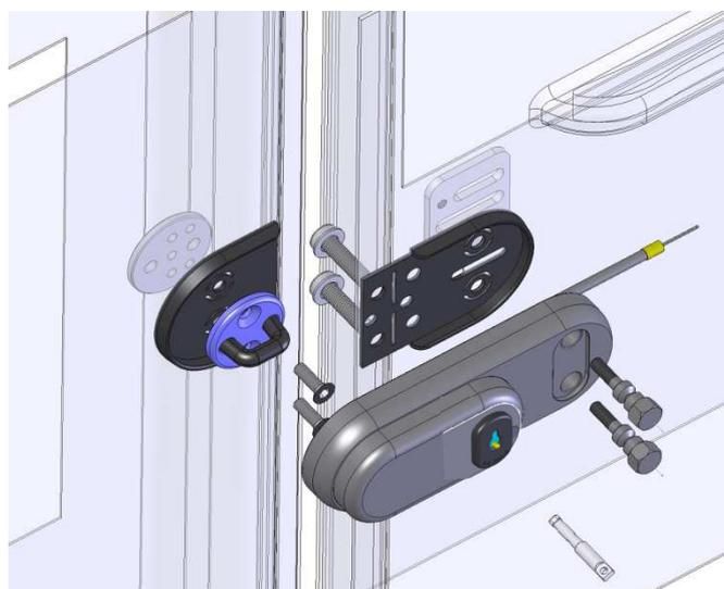
Metodo Alta Resistenza utilizzando i perni M6 anti-effrazione dall'esterno (Semplifica il montaggio e garantisce ottima resistenza).
