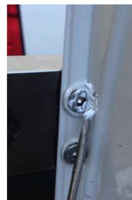
Per poter applicare la contropiastra è preferibile (non necessario) accedere alla lamiera dall'interno smontando la serratura di serie. Utilizzando chiavi snodate si può evitare lo smontaggio.
