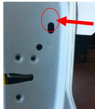
Svitare la vite di tenuta del supporto maniglia e distaccare lo stesso supporto senza estrarlo dal portellone. Lo spostamento è sufficiente a garantire l'accesso per il fissaggio della contro piastra.
