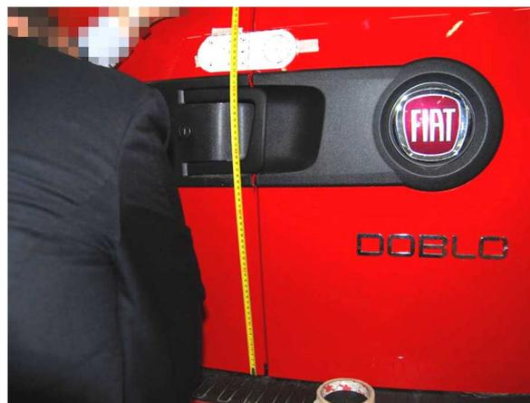
Per fissare la corazza è preferibile distaccare la serratura, senza rimuoverla completamente.
