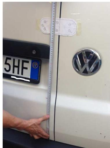
Dal momento che la dimensione del bordo interno che alloggia la testa del perno M8 a bottone è ridotta, **spostare di circa 2-3 mm la dima a destra** (in questo modo i fori si avvicinano al bordo).
