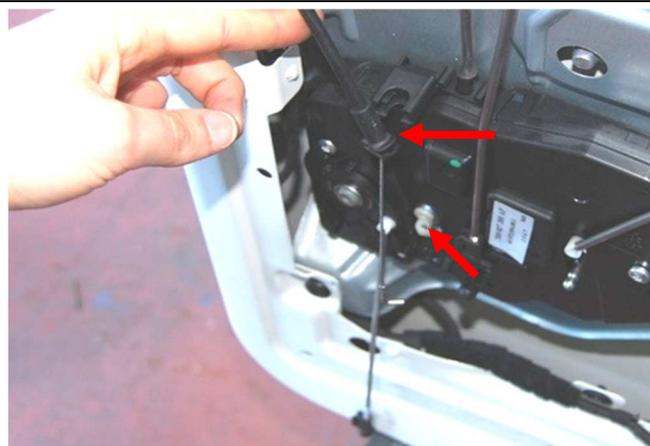
Sganciare le aste indicate in figura, prestando attenzione a segnare la posizione di origine (utilizzare un pennarello o del nastro adesivo).
