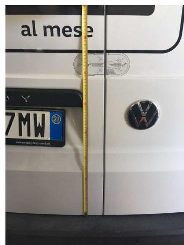
Per via della presenza di una lamiera interna di rinforzo (sotto una raffigurazione schematica) che impedisce l'accesso diretto dei dadi di fissaggio e il passaggio del cavetto di emergenza, si consiglia di segnare dall'esterno attraverso i fori appena fatti con un bulino la posizione del cavetto e dei due fori da 9mm.
