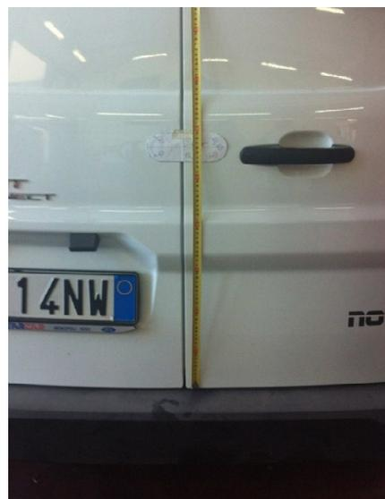
Per agevolare il fissaggio dall'interno della contro piastra della corazza, è preferibile distaccare la serratura di serie e la maniglia esterna. È sufficiente svitare le viti di fissaggio ed allontanare semplicemente senza però smontare il corpo della serratura.
