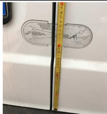
Dal momento che il bordo della porta è di piccole dimensioni e la testa del perno da M8 fornito in dotazione standard non può essere facilmente alloggiata, si consiglia di operare nel seguente modo. Allineare l'asse verticale della dima (linea tratto punto) a 4mm dallo spigolo del portellone (in altre parole spostare l'asse verticale della dima di 4mm a sinistra). Segnare il centro dei fori da 9mm. Eseguire sul bordo della porta 2 fori da 6mm (anziché da 9mm).
