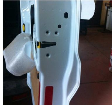
Lateralmente rispetto al portellone svitare la vite di tenuta del blocchetto esterno della maniglia (senza rimuovere completamente la stessa vite).
